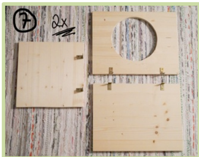
Bild 7 + 8 Winkel bündig auf alle Seitenwände schrauben. Der Abstand muss nicht genau abgemessen werden, ungefähr wie auf Bild 7 anordnen.
