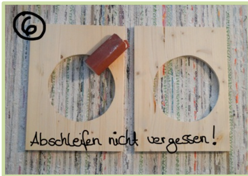
Bild 6 Alle gesägten Kanten abschleifen!
